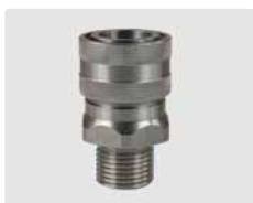
Муфта : AG. Нерж. сталь. 60° упл. конус. Макс. 250 bar / 150 °C
