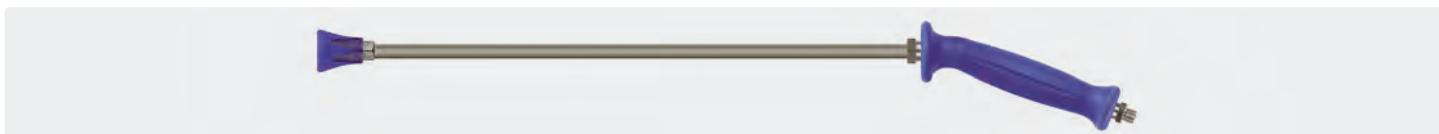
Inox. Lance avec poignée easywash365+ et porte-buse ST-10, livrée sans buse. Max. 350 bar / 45 l/min / 150 °C
