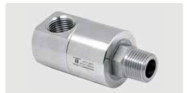
DGEI 90°. Gehäuse Edelstahl. 3-fach gelagert. Max. 350 bar
