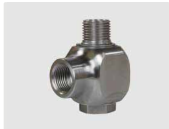
1/2" IG : 1/2" AG. DN 12. Max. 300 bar / 30 U/min / 90 °C
