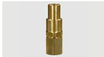
1/4" F : 1/2" F. Brass. Max. 250 bar / 90 °C
