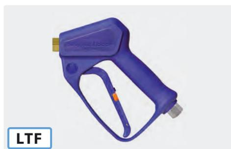
Профес. пистолет. Weep-исполнение. Вращающееся соединение с шарикоподшипником. Макс. 310 bar / 45 л/мин / 150 °C
