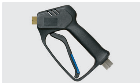
Professionelle Pistole. Weepausführung. Max. 210 bar / 25 l/min / 150 °C
