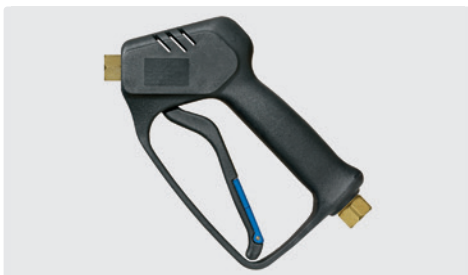
Professionelle Pistole. Weepausführung. Max. 210 bar / 25 l/min / 150 °C
