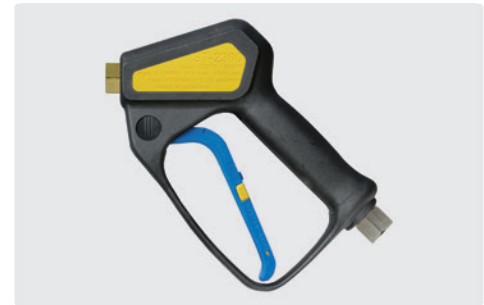
Professionelle Pistole. Weepausführung. Max. 310 bar / 45 l/min / 150 °C
