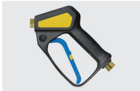
Professionelle Pistole. Weepausführung. Max. 310 bar / 45 l/min / 150 °C
