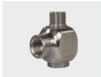
1/2" F : 1/2" M. DN 12. Max. 300 bar / 30 r.p.m. / 90 °C
