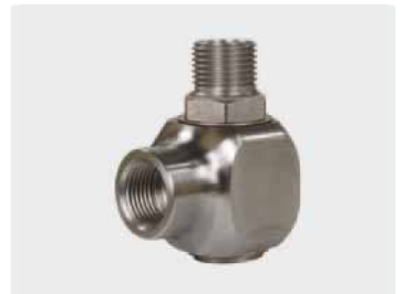
1/2" F : 1/2" M. DN 12. Max. 300 bar / 30 r.p.m. / 90 °C
