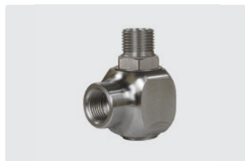
1/2" F : 1/2" M. DN 12. Max. 30 tr/min / 90 °C
