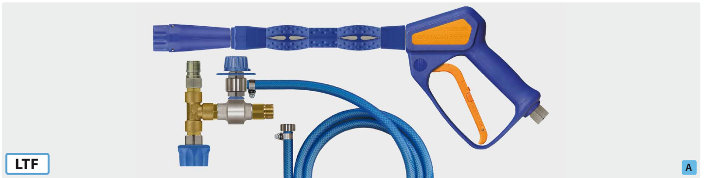
easywash365+ Schaumset: easywash365+ Schaumlanze Standard mit Schaumdüse ST-75, Injektor ST-160 (Kupplung ST-45-250 Messing vernickelt, Stecknippel ST-45-250 Stahl verzinkt und M22 AG) mit Dosierventil ST-161, Saugschlauch 1.000 mm und Saugfilter ST-32. Max. 250 bar / 90 °C
