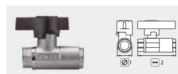
Laiton cadmié. Sphère chromée. Max. 210 bar / 80 °C
