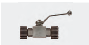
Acier zingué. Poignée zinguée. Sphère chromée. Max. 500 bar / 80 °C
