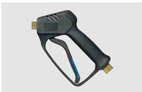
Professionelle Pistole. Weepausführung. Max. 210 bar / 25 l/min / 150 °C
