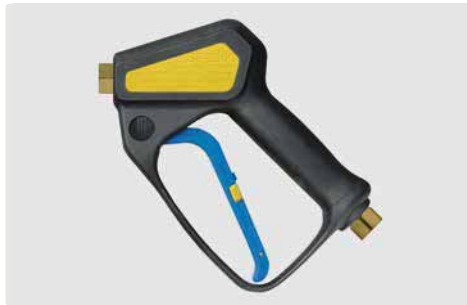
Professionelle Pistole. Weepausführung. Max. 310 bar / 45 l/min / 150 °C
