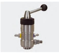
3/8" F: 1/2" F: 2 x cannelé 9 mm: Module d'air comprimé (1/4" M). Dosage produit par l'intermédiaire de 2 jeux de 10 gicleurs insérables (de 0,5 - 2,0 mm). Max. 350 bar / 100 °C
