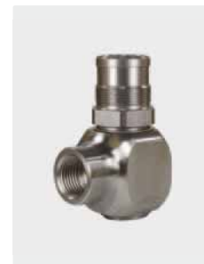
⊖ M28 M. DN 12. Max. 300 bar / 90 °C
