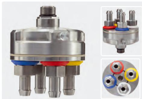
Collecteur d'aspiration pour injecteurs easy-foam365+. 4 possibilités d'aspiration avec marquage couleur. La sélection produit est obtenue grâce à la rotation indexée du disque supérieur placé sur le corps d'aspiration. Comprend 4 jeux de buses de dosage avec joint torique
