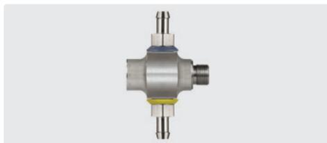
3/8" F : 3/8" M : 2 cannelés 9 mm. Injecteur pour produit mousse. L'injecteur peut aspirer et mélanger simultanément deux produits différents. Le dosage produit est calibré par l'intermédiaire de 2 jeux de 10 gicleurs de dosage insérables (0,5 - 2,0 mm).
