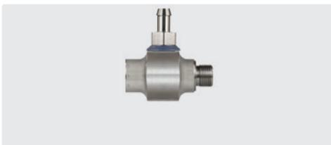
3/8" F : 3/8" M : cannelé 9 mm. Injecteur ST-160 pour produit mousse. Le dosage produit est calibré par l'intermédiaire d'un jeu de 10 gicleurs de dosage insérables (0,5 - 2,0 mm).
