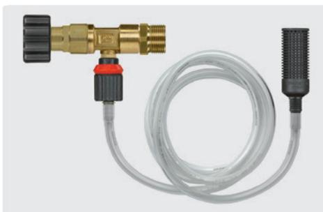
M22 F : M22 M. Injecteur avec doseur, tuyau d'aspiration 1.000 mm et crépine ST-31. Max. 250 bar / 60 °C
