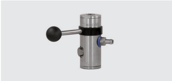
1/2" IG : 1/2" IG - Tülle 9 mm. Regulierung der Chemiedosierung erfolgt durch 10 auswechselbare Dosiereinsätze (0,5 - 2,0 mm). Max. 350 bar / 100 °C
