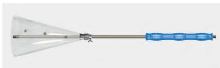
Lance avec manchon d'isolation ST-29 Cool & Compact. Prise en main ergonomique confortable. Hermétique en surface. Avec cône anti-éclaboussures, réglable par vis papillon. Max. 400 bar / 80 °C
