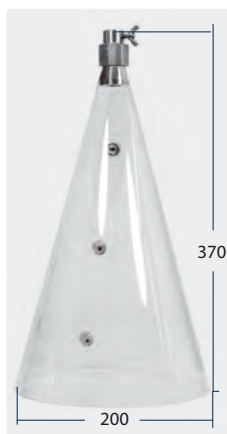
Cône de protection contre les éclaboussures en PVC, équipé d'un support en acier inoxydable avec fixation ajustable sur le tube de lance, blocage à l'aide d'une vis papillon. Max. 80 °C
