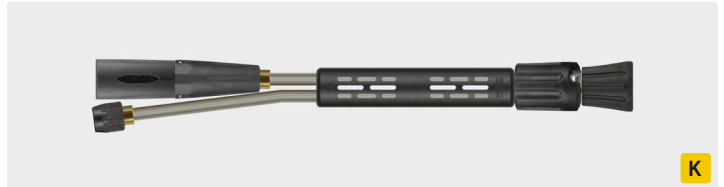
Schaumdoppellanze mit Isolierung ST-9 205 mm, Umschaltventil ST-58, ergonomische Drehverschraubung, Düsenschutz ohne Mundstück und Schaumkopf ST-75.1 ohne Düse. Es wird ein Schauminjektor benötigt. Max. 350 bar / 45 l/min / 100 °C
