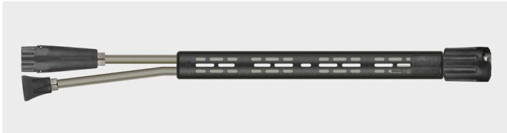
Schaumdoppellanze mit Isolierung ST-9 380 mm, Umschaltventil ST-58, Düsenschutz ST-10 ohne Düse und Schaumkopf ST-75 ohne Düse. Es wird ein Schauminjektor benötigt. Max. 350 bar / 45 l/min / 100 °C
