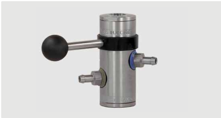
1/2" IG : 1/2" IG. Injektor mit Tülle 9 mm und Druckluftmodul (Tülle 9 mm). Regulierung der Chemiedosierung erfolgt durch 10 auswechselbare Dosiereinsätze (0,5 - 2,0 mm). Max. 350 bar / 100 °C
