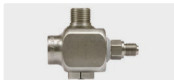
1/4" AG : 1/2" AG dreh. : 1/2" IG. Edelstahl. Zum Einblasen von Druckluft. Max. 350 bar / 60 °C
