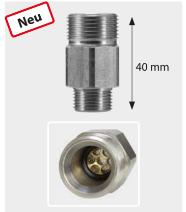
Edelstahl mit Siebhalter aus Messing. Geeignet als Vorfilter für Injektor ST-164. Max. 400 bar / 100 °C
