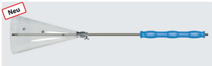
Strahlrohr mit Isolierung ST-29 Cool & Compact. Angenehm ergonomisch geformter Griff. Geschlossene Oberfläche. Mit Spritzschutztrichter, einstellbar mit Flügelschraube. Max. 400 bar / 80 °C
