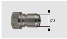
Stecknippel : 1/2" IG. Edelstahl. Max. 250 bar / 150 °C
