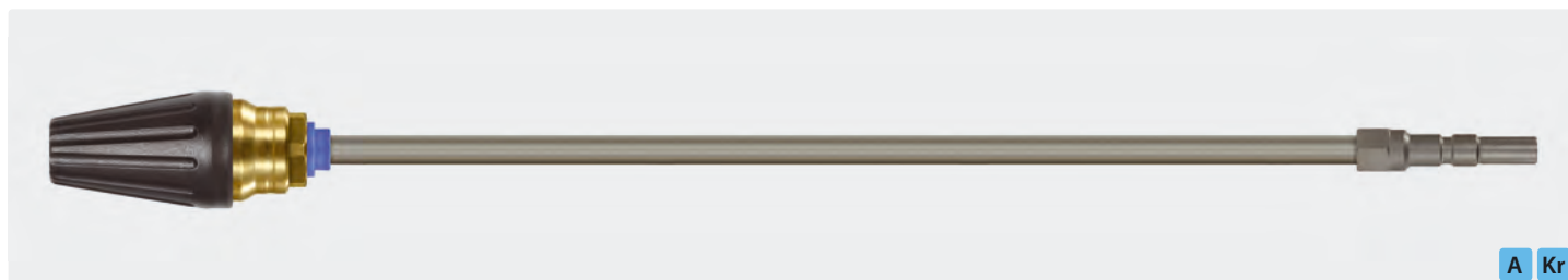
Coupleur KW. Lances tube zingué avec rotabuse ST-458.1. Cône 20°. 200 - 400 bar. Max. 100 °C
