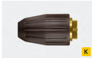
M18 F. Cône 20°. 200 - 350 bar. Max. 100 °C
