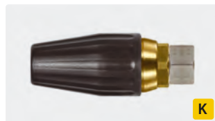
M18 F. Cône 20°. 100 - 250 bar. Max. 100 °C
