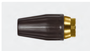
1/4" F. Cône 20°. 100 - 250 bar. Max. 100 °C
