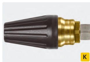
M18 F. Cône 20°. 200 - 400 bar. Max. 100 °C
