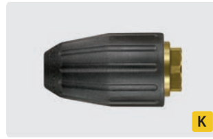
M18 F. Spray angle 20°. 200 - 350 bar. Max. 100 °C
