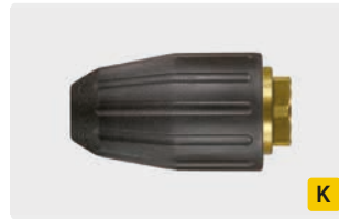
M18 IG. Spritzwinkel 20°. 200 - 350 bar. Max. 100 °C
