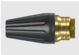
1/4" F. Spray angle 20°. 200 - 400 bar. Max. 100 °C
