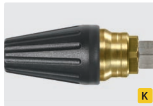
M18 F. Spray angle 20°. 200 - 400 bar. Max. 100 °C
