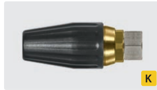
M18 F. Spray angle 20°. 100 - 250 bar. Max. 100 °C
