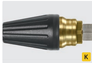
M18 IG. Spritzwinkel 20°. 200 - 400 bar. Max. 100 °C
