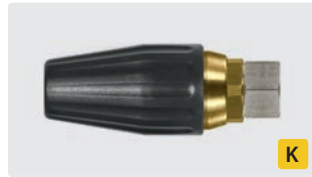
M18 IG. Spritzwinkel 20°. 100 - 250 bar. Max. 100 °C
