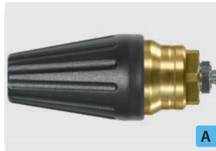
1/8" AG. Spritzwinkel 20°. 200 - 400 bar. Max. 100 °C
