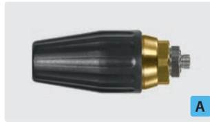
1/8" AG. Spritzwinkel 20°. 100 - 250 bar. Max. 100 °C
