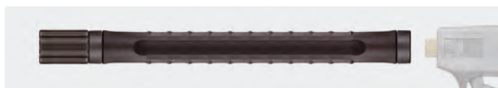
1/4" M. Manchon avec isolation ST-9.9-19 330 mm et raccord manuel M22. Max. 400 bar / 150 °C
