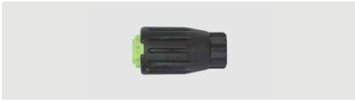
1/4" F. Spray angle 17°. 50 - 150 bar. Max. 60 °C
