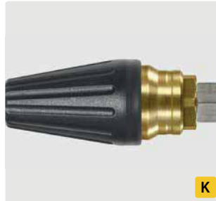
M18 F. Spray angle 20°. 200 - 400 bar. Max. 100 °C
