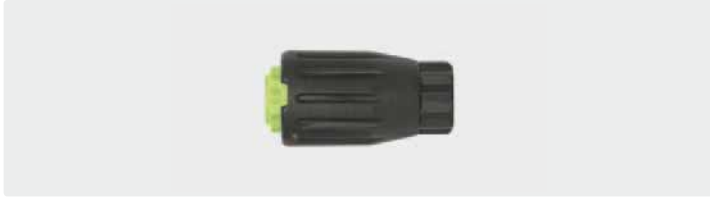
1/4" F. Spray angle 17°. 50 - 150 bar. Max. 60 °C
