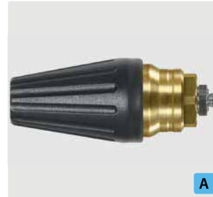
1/8" AG. Spritzwinkel 20°. 200 - 400 bar. Max. 100 °C
