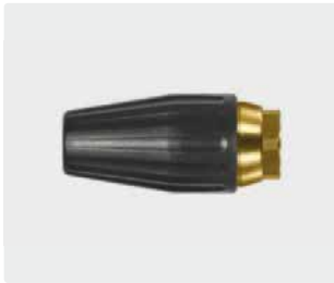
1/4" F. Spray angle 20°. 100 - 250 bar. Max. 100 °C
