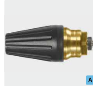
1/8" M. Spray angle 20°. 200 - 400 bar. Max. 100 °C
