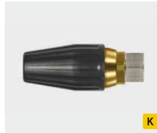
M18 F. Spray angle 20°. 100 - 250 bar. Max. 100 °C
