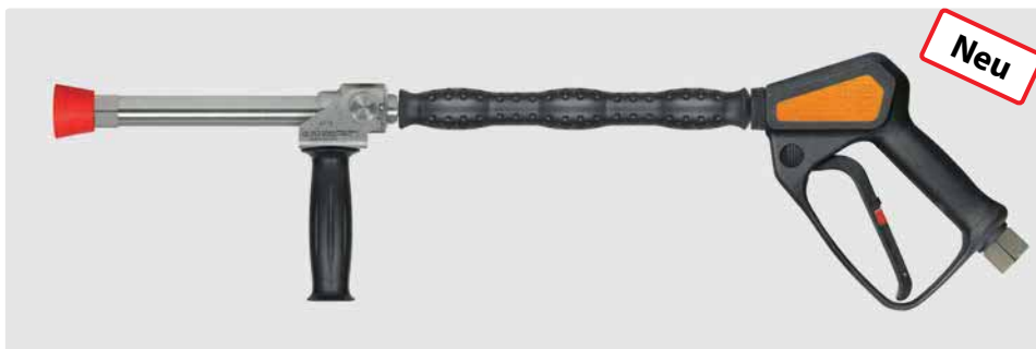
1/2" IG. Edelstahl. Weitwurflanze 300 mm mit Isolierung ST-29 Cool & Compact 330 mm, Pistole ST-2320, seitlichem Handgriff und Düsenschutz aus Kunststoff ohne Düse. Max. 150 bar / 80 l/min / 100 °C
