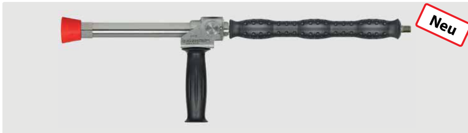
1/4" AG. Edelstahl. Weitwurflanze 300 mm mit Isolierung ST-29 Cool & Compact 330 mm, seitlichem Handgriff und Düsenschutz aus Kunststoff ohne Düse. Max. 280 bar / 130 l/min / 100 °C
