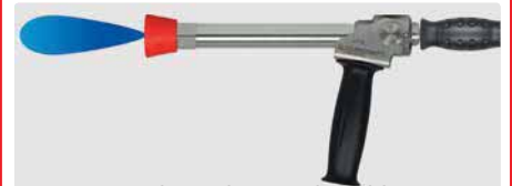
1/4" AG. Edelstahl. Weitwurflanze 300 mm mit Isolierung ST-29 Cool & Compact 330 mm, seitlichem Handgriff und Düsenschutz aus Kunststoff ohne Düse. Max. 280 bar / 130 l/min / 100 °C
