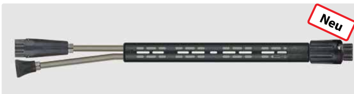
Schaumdoppellanze mit Isolierung ST-9 380 mm, Umschaltventil ST-58, Düsenschutz ST-10 ohne Düse und Schaumkopf ST-75 mit Düse. Es wird ein Schauminjektor benötigt. Max. 350 bar / 45 l/min / 100 °C
