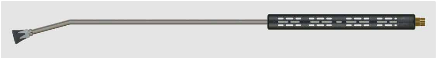
M22 AG. Strahlrohr mit Isolierung ST-9 und Düsenschutz ST-10 ohne Hochdruckdüse. Max. 400 bar / 150 °C
