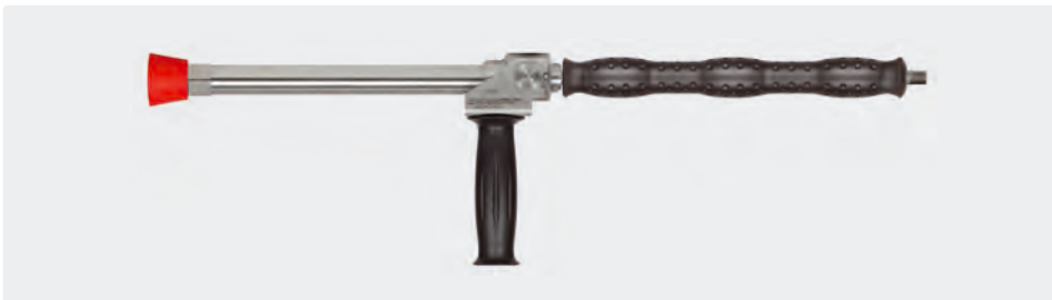
Lance d'hydro-balayage 350 mm acier inoxydable avec manchon ST-29 Cool & Compact 330 mm, poignée latérale et protège-buse en PVC, livrée sans buse. Max. 280 bar / 130 l/min / 100 °C
