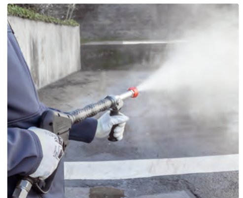
Lance d'hydro-balayage 350 mm acier inoxydable avec manchon ST-29 Cool & Compact 330 mm, poignée latérale et protège-buse en PVC, livrée sans buse. Max. 280 bar / 130 l/min / 100 °C
