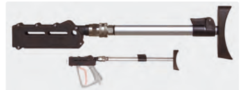
Crosse de pistolet ST-3900 extensible. La nouvelle directive UE prescrit l'usage obligatoire d'une crosse de maintien à partir d'une force de recul supérieure à 150 N. Crosse réglable équipée d'un coupleur rapide rotatif.
