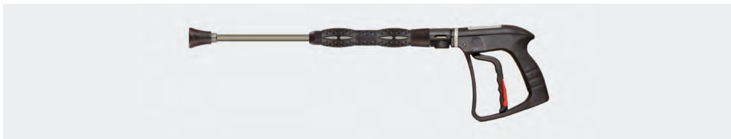
Pistolet vapeur ST-860D professionnel avec lance en inox 400 mm, manchon ST-9.1 220 mm et porte-buse ST-12, livré sans buse. Max. 20 bar / 200 °C
