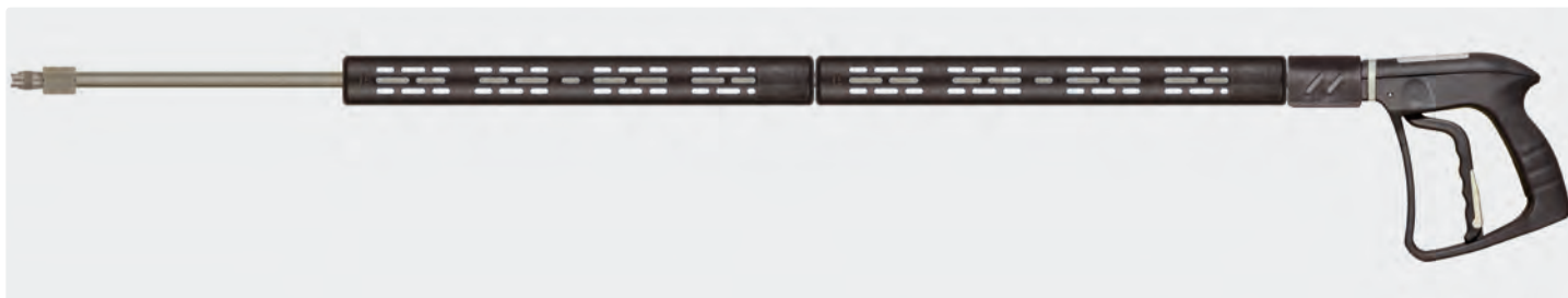
Pistolet vapeur ST-4000 professionnel équipé d'un clapet pleureur avec lance en inox, demi-coquilles ST-9 380 mm et buse vapeur basse-pression en inox. Max. 20 bar / 200 °C
