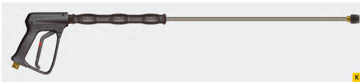
Pistolet professionnel R+M EcoLine No. ONE avec lance 900 mm en acier zingué, manchon ST-28 Cool & Compact 300 mm et porte-buse pastille, livré sans buse. Max. 250 bar / 45 l/min / 150 °C
