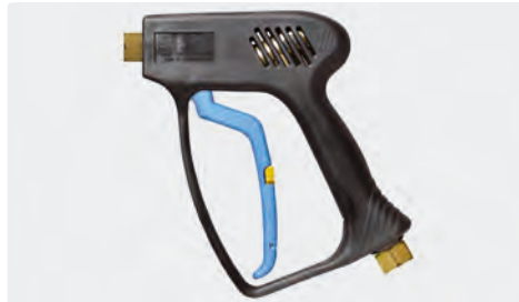
Pistolet professionnel. Version hors-gel pleureur. Max. 275 bar / 45 l/min / 150 °C
