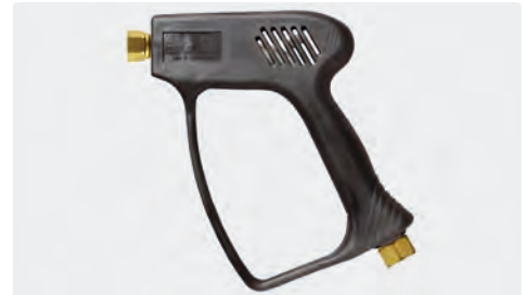
Pistolet professionnel sans clapet (passage libre). Max. 275 bar / 45 l/min / 150 °C
