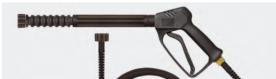
Pistolet professionnel avec manchon 340 mm, max. 210 bar / 25 l/min / 150 °C. Entrée / sortie M22 F. Équipé d'un flexible PVC 6 - 160 avec 1 tresse synthétique, max. 160 bar / 20 °C
