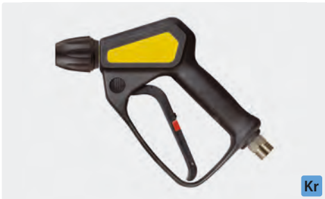
Pistolet professionnel avec coupleur KW. Max. 310 bar / 45 l/min / 150 °C
