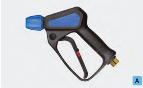
Pistolet professionnel avec coupleur KW. Max. 310 bar / 45 l/min / 150 °C
