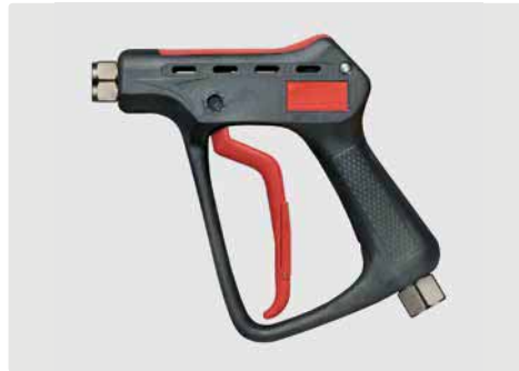
Professionelle Höchstdruckpistole. Max. 600 bar / 80 l/min / 150 °C
