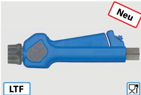
Professionelle Pistole mit Abschaltverzögerung, Öffnungsarretierung und Kupplung ST-3100. Edelstahl. Anwendung z. B. Schaum- und Spülanwendungen in der Lebensmittelindustrie. Industriestandard. Max. 24,5 bar / 120 l/min / 100 °C
