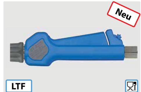
Professionelle Pistole mit Öffnungsarretierung und Kupplung ST-3100. Edelstahl. Anwendung z. B. Schaum- und Spülanwendungen in der Lebensmittelindustrie. Industriestandard. Max. 24,5 bar / 120 l/min / 100 °C
