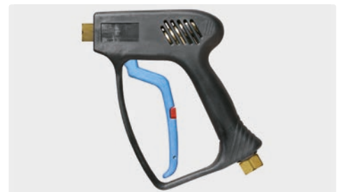
Professionelle Pistole. Frostschutzausführung. Max. 275 bar / 45 l/min / 150 °C
